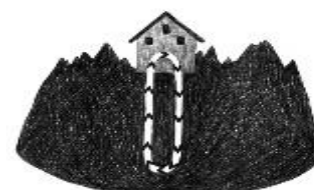
System: WÄRMEPUMPE MIT ERDSONDE
